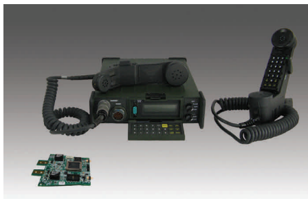
Le système de chiffrement radio militaire DSP 9000 est disponible sous forme de station de base, de combiné et de circuit intégré
